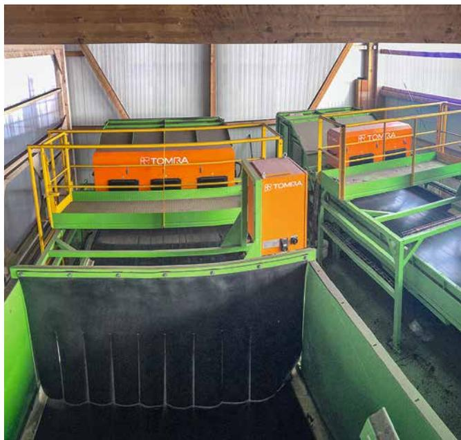
Une installation de tri optique a été mise en service durant l'exercice. Plastique, aluminium, fer et autres impuretés, sont ainsi extraits du compost. Une première en Suisse et en Europe !
